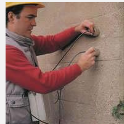
PN-EN 12504-4 Metoda ultradźwiękowa – metoda pośrednia
