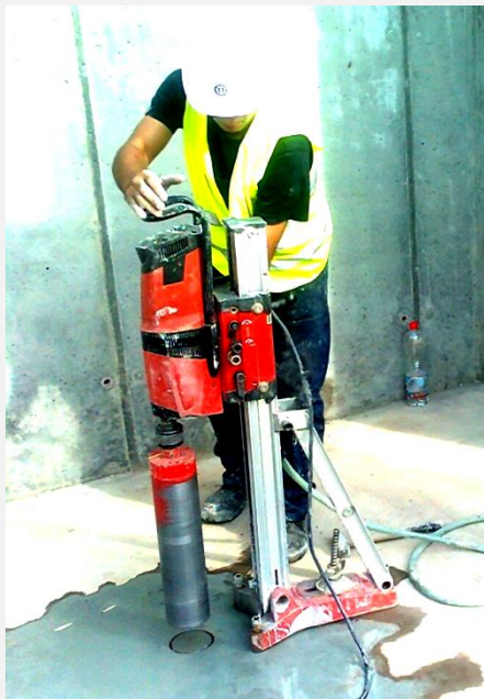
PN-EN 12504-1 Odwierty rdzeniowe – metoda bezpośrednia
